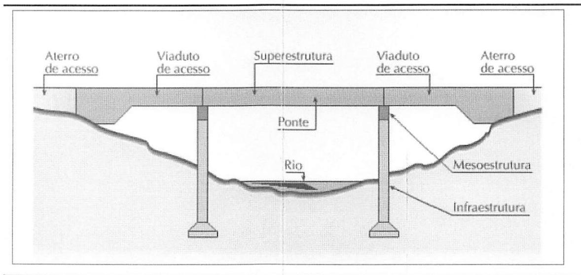
A superestrutura é o componente superior da ponte, constituída do estrado e dos elementos que suportam o estrado e todas as cargas nele aplicada. A função estrutural da superestrutura é a de transmitir as cargas, ao longo dos vãos, para os apoios. O estrado é o elemento da ponte onde a carga móvel atua diretamente, devendo ser capaz de permitir um tráfego seguro e fluente. **No caso deste projeto, o estrado será composto de madeira.**
